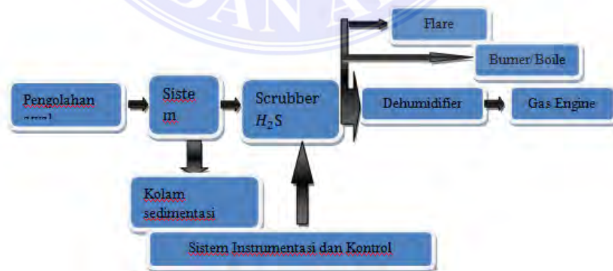
Gambar 2.1 Diagram Pembangkit Listrik Tenaga Biogas. Sumber : Winrock
