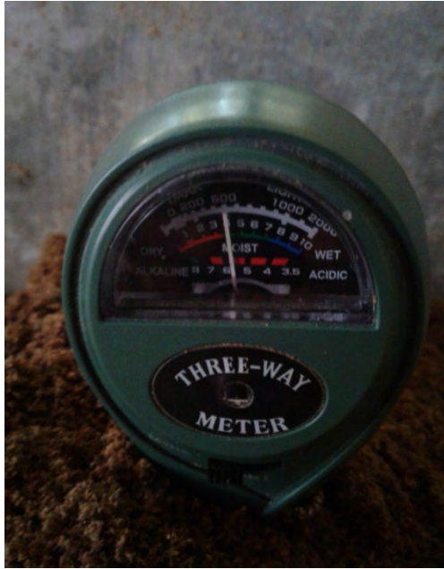
Gambar 4. Alat Pengukur pH selama Pengomposan
