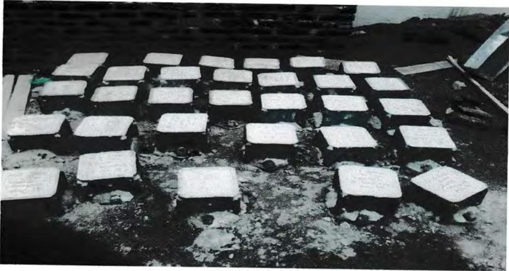
Gambar : Uji test mutu beton
