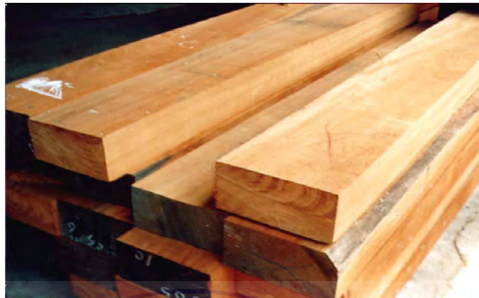
Gambar 2.5 Kayu broti untuk konstruksi bekisting (Sumber: Google )
