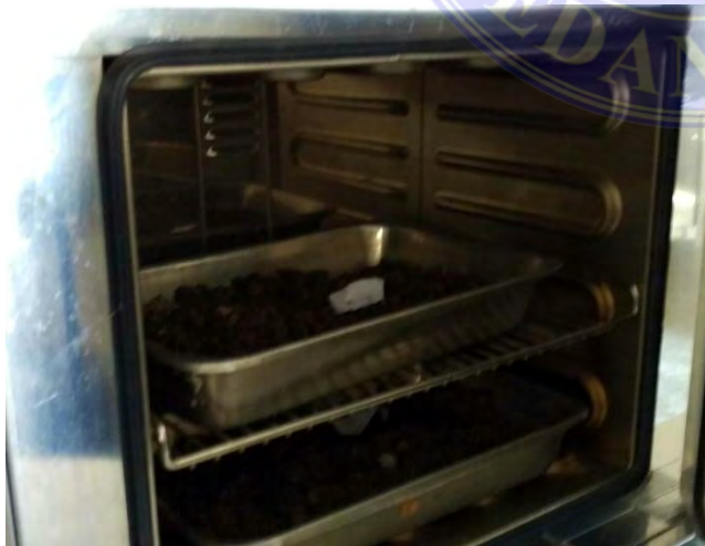
Gambar 3. Pengovenan Material Split Gambar 4. Pengujian Analisa Ayak Split
