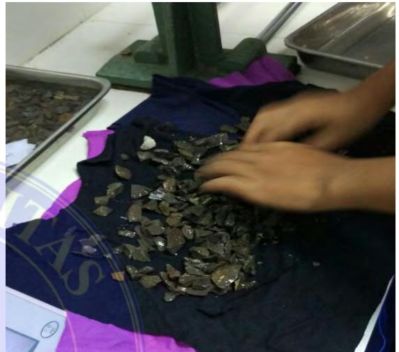
Gambar 2. Kondisi Split dalam Keadaan SSD
