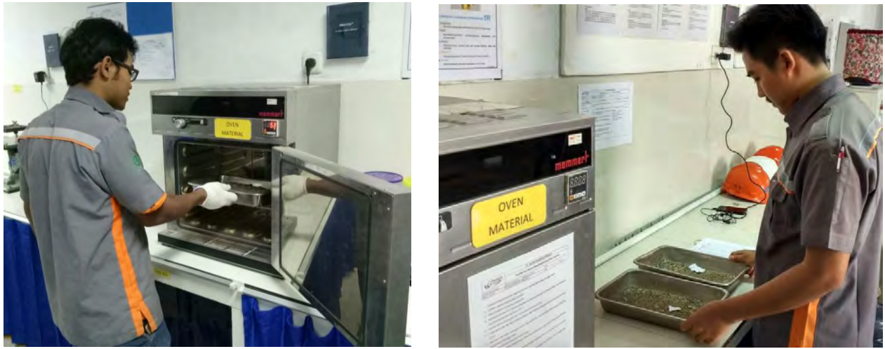
Gambar 4. Pengovenan Material Pasir
