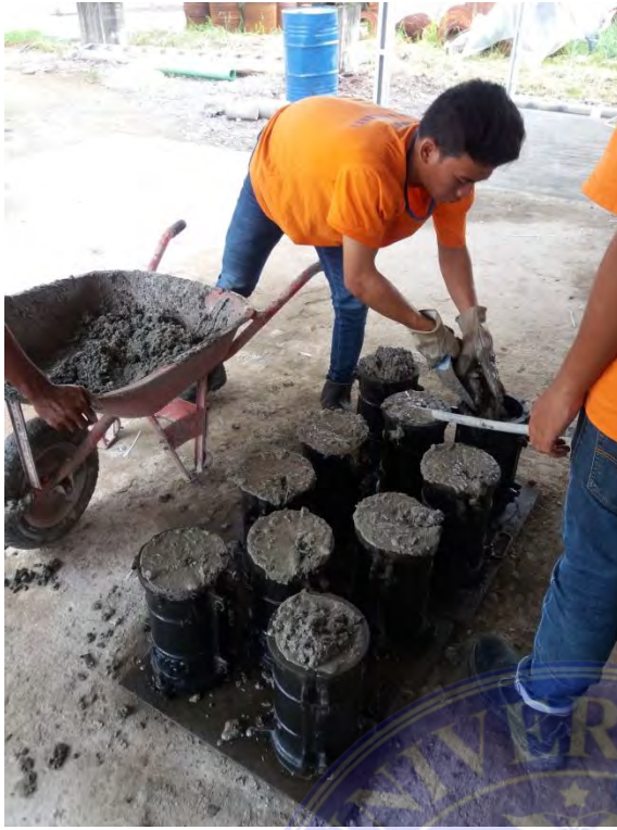
Gambar 5. Pembuatan Benda Uji Silinder
