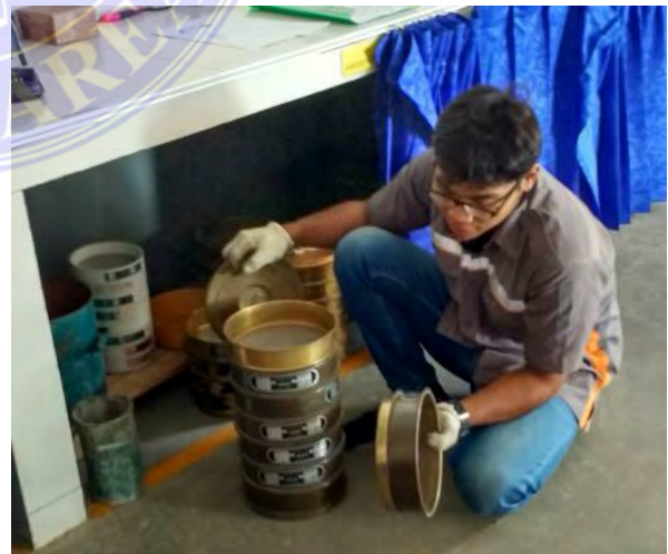
Gambar 3. Pengovenan Material Split Gambar 4. Pengujian Analisa Ayak Split
