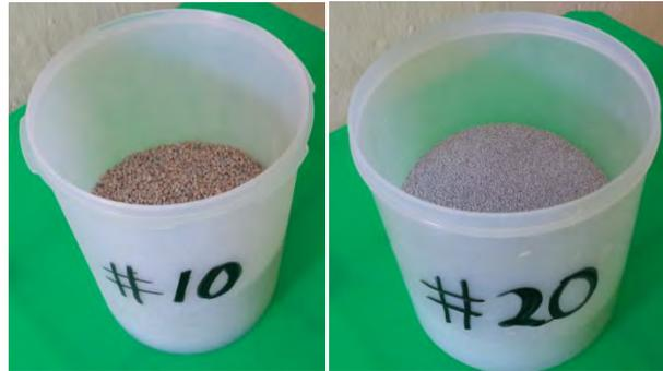
**Gambar 3.1 Bahan Zeolit Dengan Ukuran Butir Yang Berbeda**
