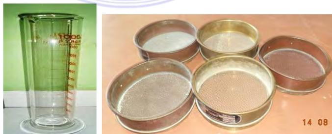
**Gambar 3.2 Gelas Ukur Kapasitas 500 ml dan saringan**
