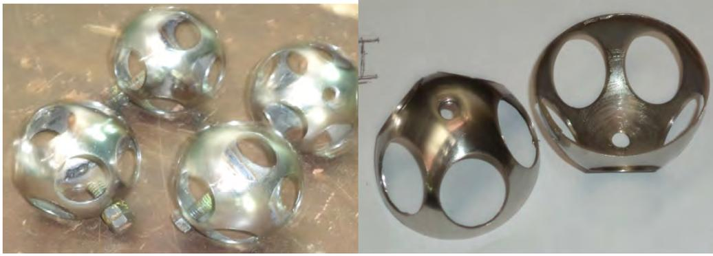
Gambar 5. Hasil pembuatan bagian dalam knalpot
