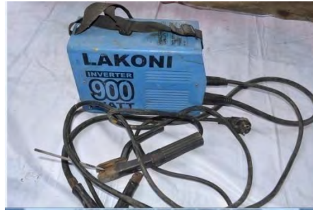
Gambar 3.3. Trafo las listrik
